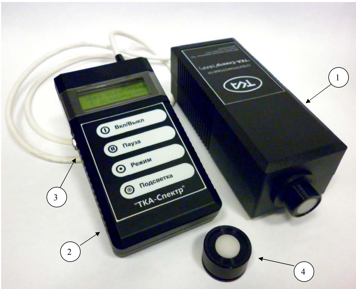
Рис. 2. Внешний вид прибора (сборка 2016 года, прошивка v.4.0.2_PAR) 1 – оптоэлектронный блок – ФАР, 2 – блок обработки сигнала 3 – разъем DC IN, 4 – ослабитель (косинусный корректор-ослабитель)
