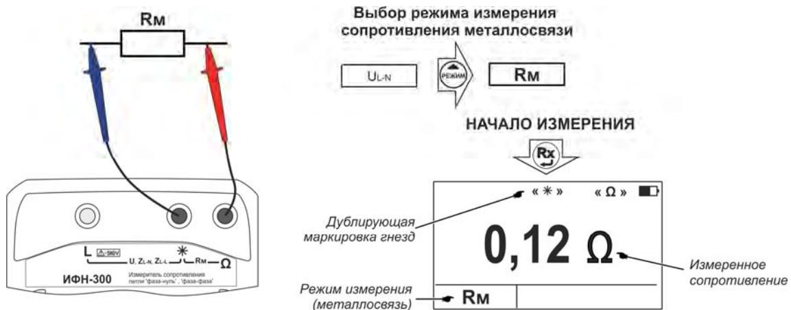
Рисунок 2.7 - Измерение сопротивления металlosвязи
