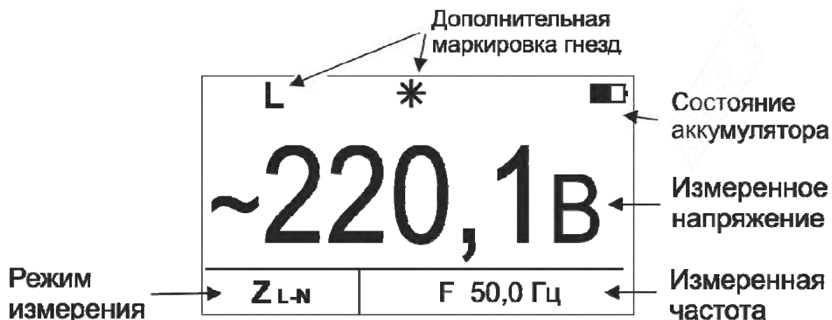
Рисунок 2.4. - Измерение напряжения и частоты
