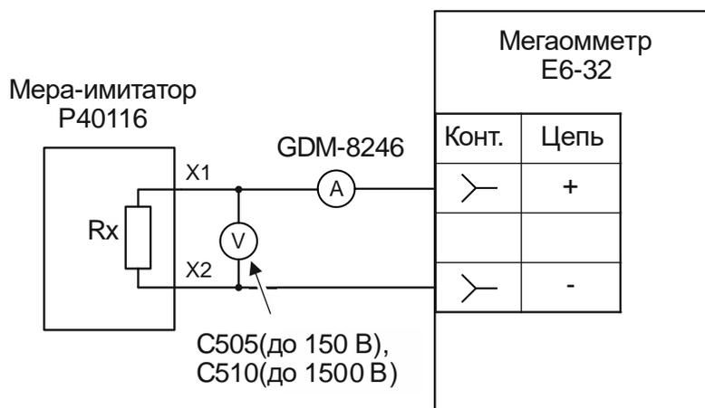
Рисунок 6.3 - Схема проверки погрешности при измерении классификационного напряжения
