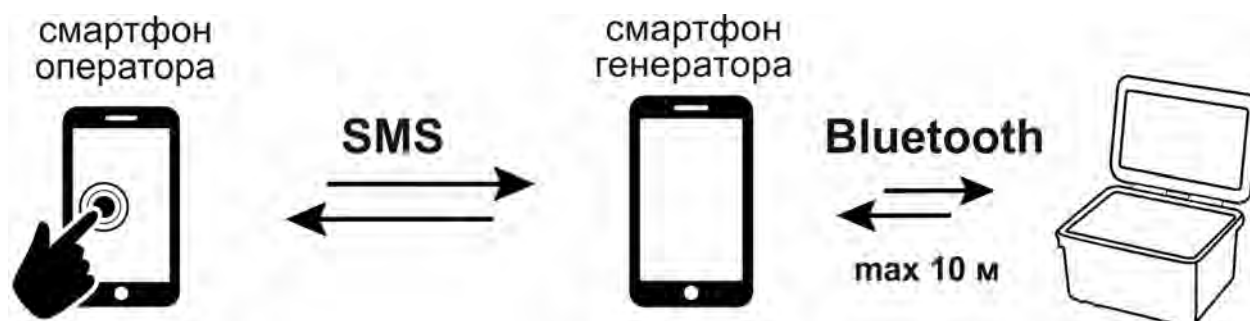
Рисунок 2.8 – Организация дистанционного управления генератором
