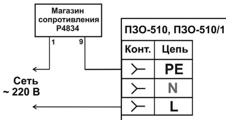
Рисунок 6.7.5 - Схема проверки погрешности измерений напряжения прикосновения
